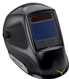
Casque pour soudage à l'arc électrique avec écran auto obscurcissant. Peut être utilisé pour la soudure MIG, MAG, TIG et plasma nécessitant une protection de teinte 9 à 13. Peut être utilisé pour de la soudure à faible intensité ou à la flamme teinte 5 à 9. Peut être utilisé pour le meulage en teinte 4.
