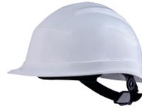
Casque de chantier en ABS-PC. Coiffe en polyamide : 3 bandeaux textiles avec 8 points de fixation. Basane éponge. Serrage à bouton : tour de tête de 53 à 63 cm. 2 positions possibles du tour de tête (haut/bas) pour un meilleur confort. Isolement électrique jusqu'à 1000VAC ou 1500VCC.
