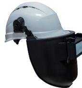
Masque de soudage en polypropylène adaptable sur casque de chantier. Pour tout type de soudage qui nécessite une protection teinte 11. Vendu prêt à l'emploi : fenêtre fixe équipée d'un filtre polycarbonate incolore (FILTER-IN), fenêtre relevable équipée d'un filtre teinté 11 (FILTER-11) protégé par un filtre polycarbonate incolore (FILTER-IN). Dimensions des filtres : 108 x 51 mm.
