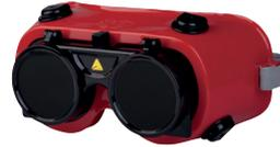
Lunettes masques soudeur. Ecran relevable. Monture PVC souple. Ventilation indirecte. Bandeau élastique. Oculaires intérieurs polycarbonate incolore. Oculaires supérieurs polycarbonate teinte 5 avec verre de garde polycarbonate incolore.
