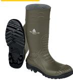
Tige: PVC. Doublure: polyester. Protection des malléoles. Pare-chocs de protection avant et arrière. Ergot de déchaussement. Embout de protection : acier inoxydable. Semelle anti-perforation : acier inoxydable. Semelle: PVC - Nitrile.
